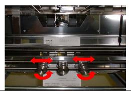
① 両側の白いローラー2つは必ず用紙を押える位置に調 整します ② 丸いノブを1回転緩める ③ 左右に手で移 動して ④ 丸いノブを逆に回してロックします
